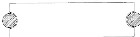
figura 2: vista superior da placa e guias cilíndricas
